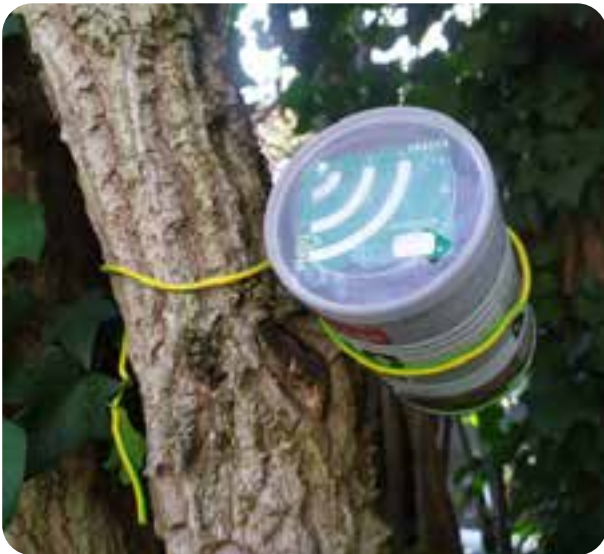
Photographie de : ©Héloïse JEUX, Juin 2024, Strasbourg L'appareil vert visible dans la capsule est un audiomoth. Ainsi fixé en hauteur, il enregistre les bandes sons ensuite analysées par BirdNET pour la reconnaissance des espèces d'oiseaux
